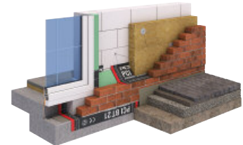
System zweischaliges Mauerwerk
